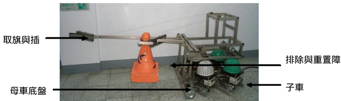
圖 5 線控機器人行走部之實際運動操作測試(母車排除障礙)
