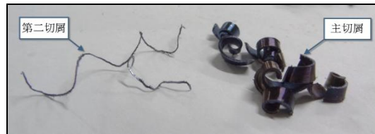
圖 7. 第二切屑示意圖
