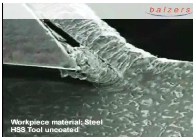
圖 6. 尖刀刀具切削金屬時產生的 Built-up edge
