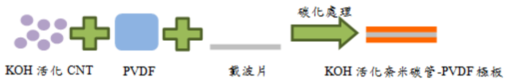
圖 7. CNT-PVDF 極板製作步驟圖
