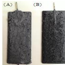
圖 8. 極板成品(A)CNT-PVDF 極板；(B)經 KOH 活化 CNT-PVDF 極板
