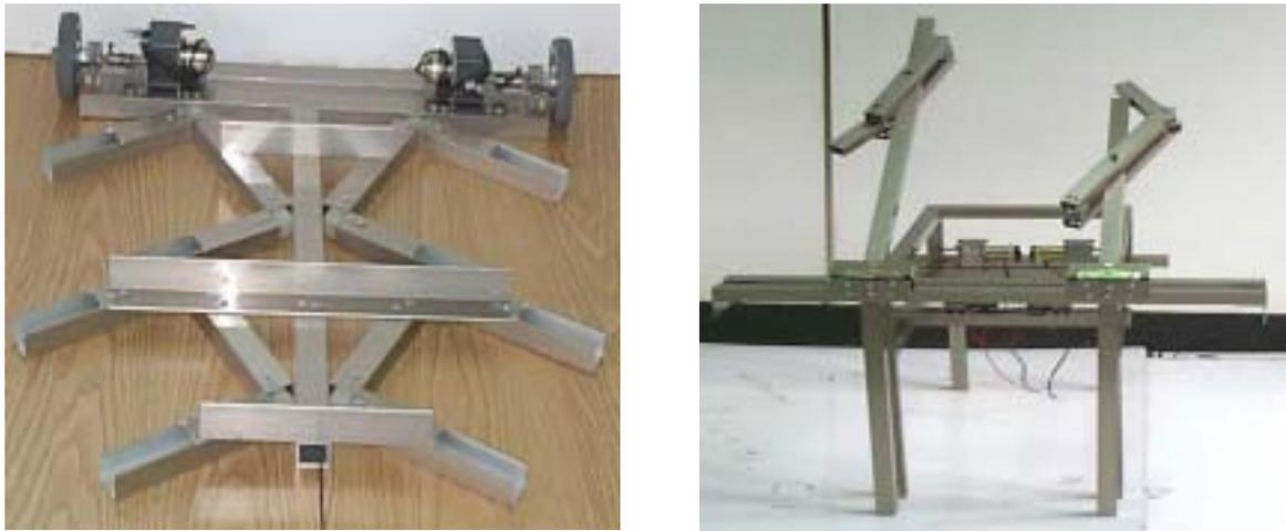
圖 8 母車底盤(左)、車架與上半部機構(右)製作成品
