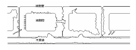
圖 1 細菌對木材細胞壁的破壞方式
