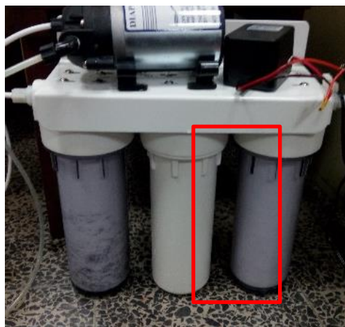
圖 12. 逆滲透淨水器設備
