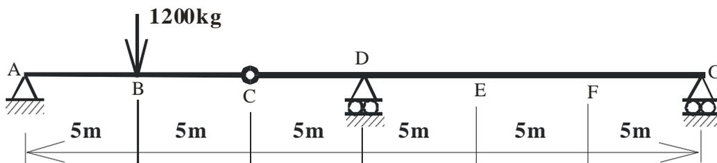
3. 請求出上圖所示樑在圖示外力作用下斷面 E 的剪力  $V_E$  與斷面 F 的彎矩  $M_F$ 。(共 20 分)
